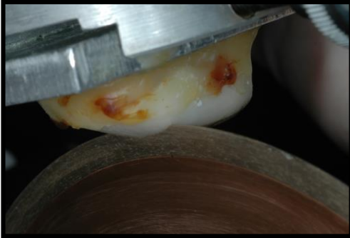
Figura 4 – Corte do dente bovino com disco diamantado
