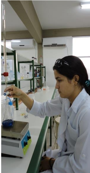
Figura 11: Padronização da solução de Fehling no início.
