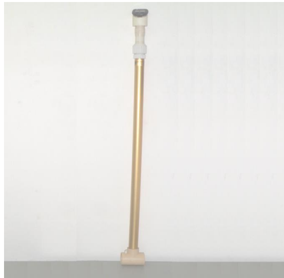
Figura 3: Molinete para medição de velocidade da água.
