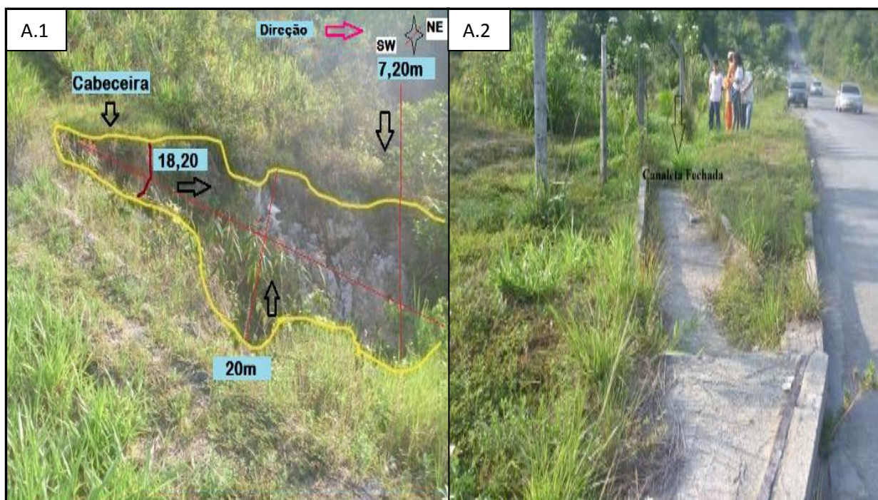
Figura (A.1): Voçoroca 01, traçado amarelo indica os limites da incisão, setas indica comprimento, Largura, profundidade e cabeceira. Fonte: Anne Dirane, 2012 Figura (A.2): indica canaleta presente Fonte: Anne Dirane 2012.
