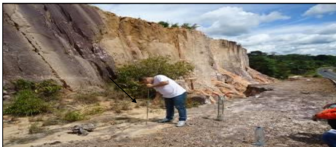
Figura (6): Teste de resistência a penetração no solo. Fonte: Anne Dirane, 2013
