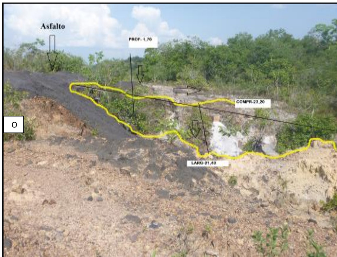
Figura (P): Voçoroca 14, 1º monitoramento- traçado amarelo indica os limites da incisão, setas indicam comprimento, largura e profundidade. Fonte: Anne Dirane, 2012.
