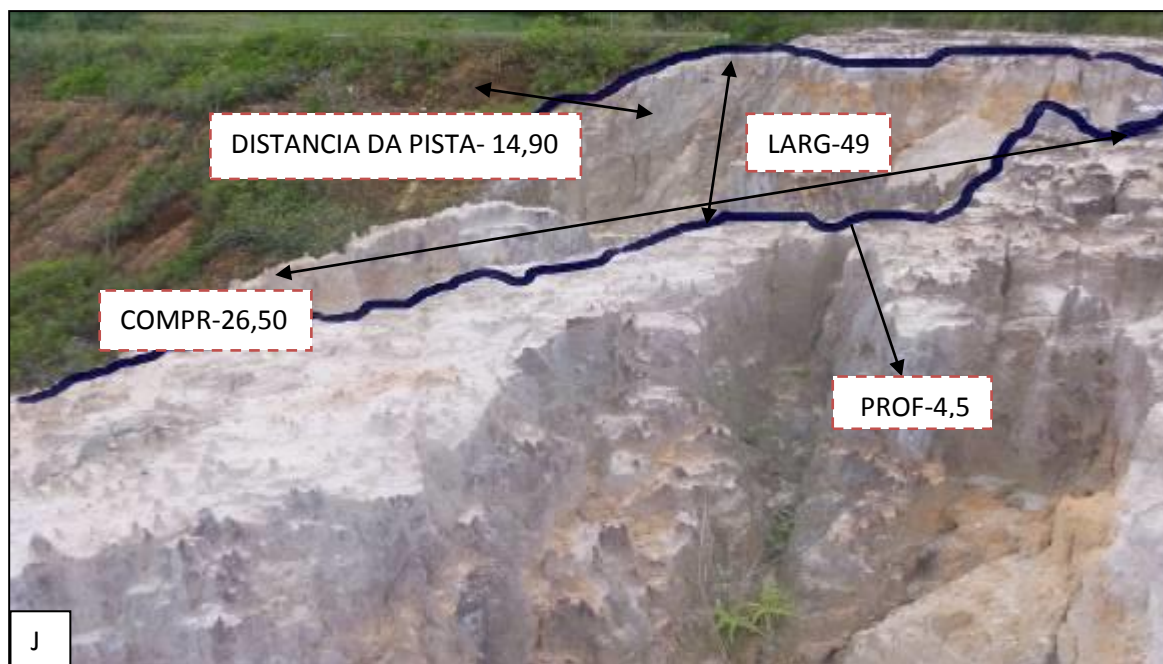
Figura (J): Voçoroca 09, 2° monitoramento- traçado azul indica os limites da incisão, setas indicam comprimento, largura, profundidade e distancia da pista. Fonte: Anne Dirane, 2013
