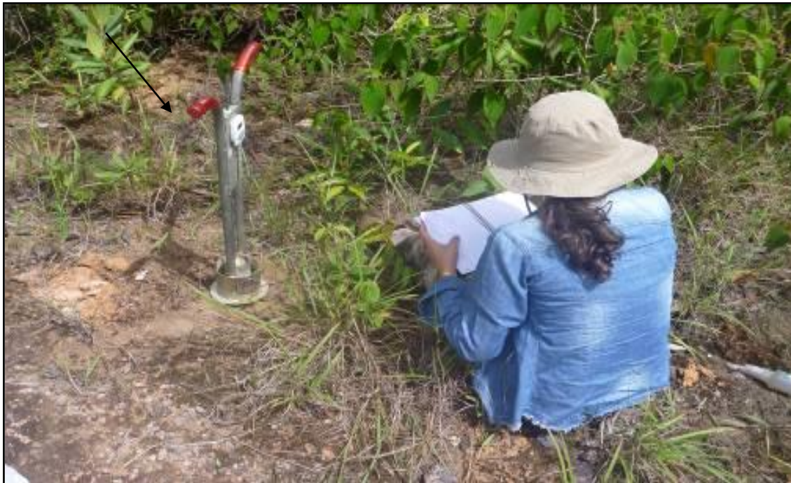
Figura (7): Teste de resistência a infiltração de água no solo. Fonte: Anne Dirane, 2013.
