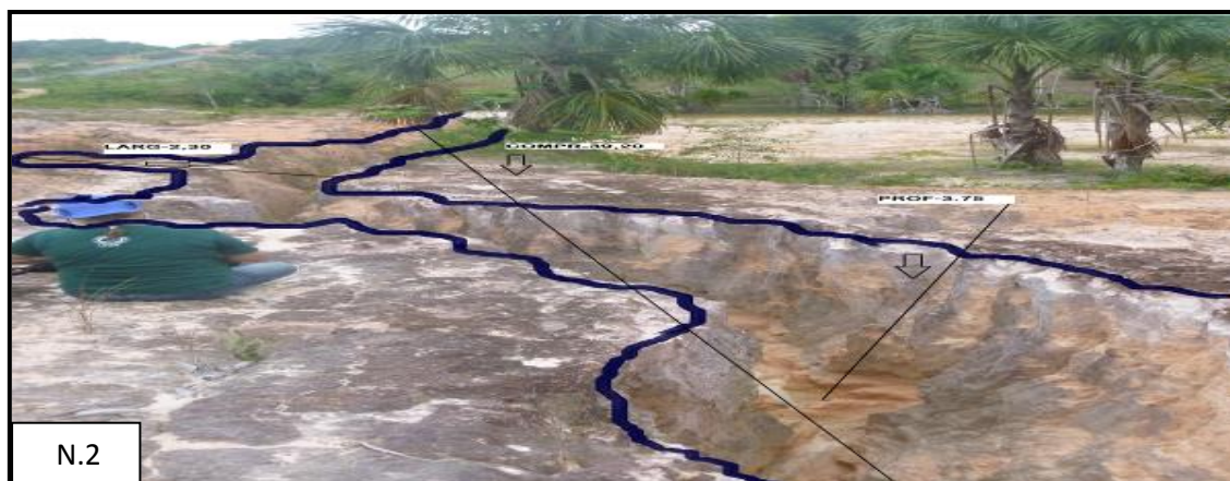
Figura (N.2): Voçoroca 13, 2º monitoramento- traçado azul indica os limites da incisão, setas indicam comprimento, largura, profundidade. Fonte: Anne Dirane, 2013.
