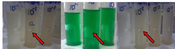
Figura 3. Formação de bolha no interior do tubo Durham, indicando positividade para CL, VB e EC.
