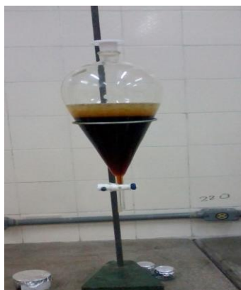
Figura 4: Realização da extração líquido-líquido em funil de separação. Solução amarela: hexano. Solução preto-amarronzada: Solução hidro alcoólica.
