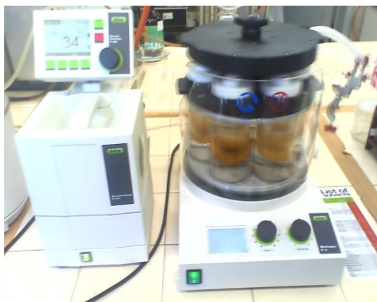
Figura 5: Processo de evaporação da fase butanólica em multivapor.
