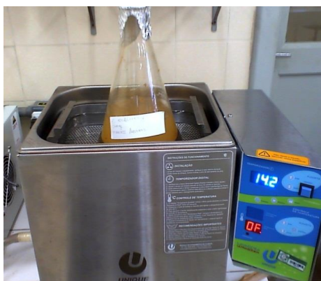
Figura 2: Banho de ultrassom aplicado durante a extração com hexano.
