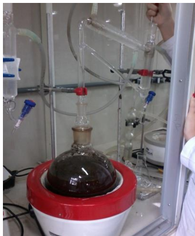
Figura 3 - Sistema Clevenger adaptado
