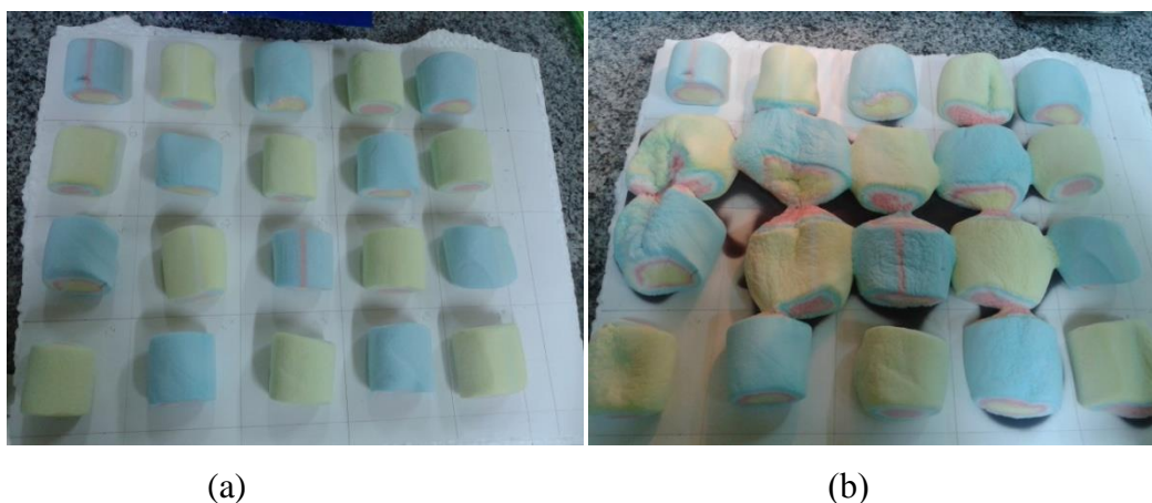
Figura2. (a) marshmallows após ser irradiado com o prato giratório, (b) marshmallows após irradiação sem o prato giratório.
