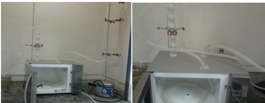
Figura 4. Montagem final do microondas, já com todos os componentes acoplados.
