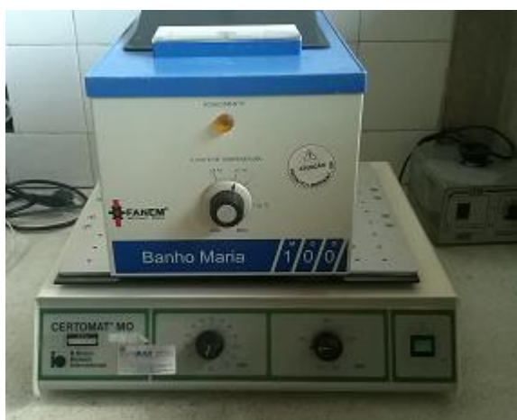
Figura 6. Amostras durante o ciclo de DES/RE em banho maria, sob constante agitação.
