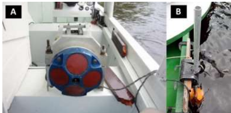
Fig. 2 - A: Perfilador Acústico Doppler de Corrente – ADCP; B: Suporte de alumínio. Fonte: ORE-HYBAM; André Zumak
