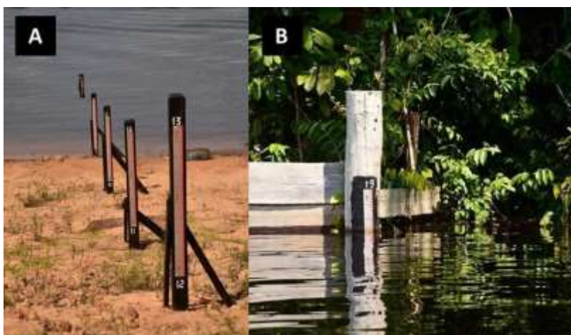
Fig. 4 – A: Réguas Linimétricas (cota baixa do Rio Negro); B: Ultima Régua (cota alta do Rio Negro). Fotos: André Zumak
