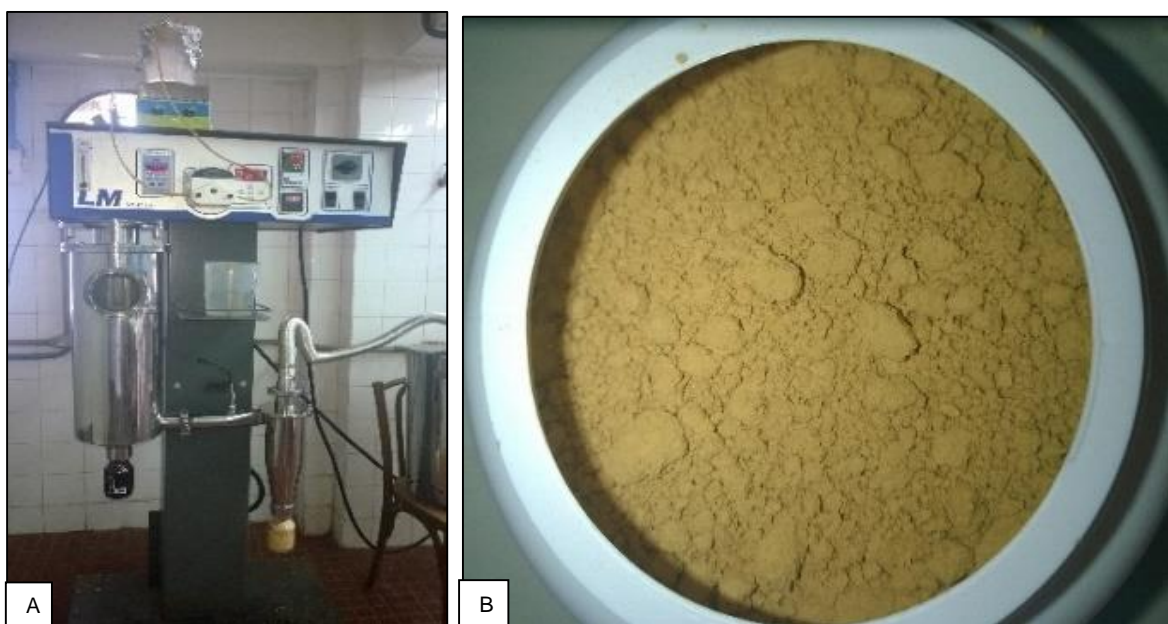
Figura 3. A. Spray drier em funcionamento. B. Produto Seco pó Asperão
