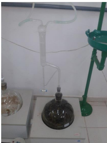
Figura 3. Material vegetal submetido a hidrodestilação.
