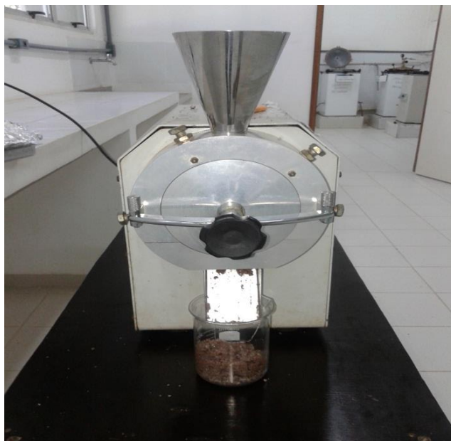
Figura 6. Moinho de facas utilizado para moer as amêndoas de inajá.
