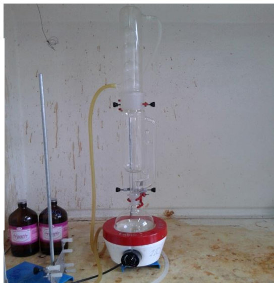
Figura 5. Extrator Soxhlet utilizado na extração do óleo de inajá.
