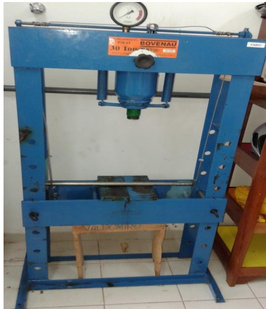
Figura 3. Prensa hidráulica utilizada na extração do óleo das amêndoas de inajá.
