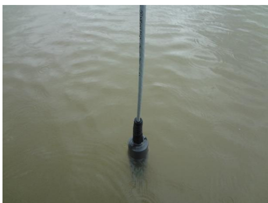
Figura 5. Aparelho multiparâmetro modelo Hanna HI 9828
