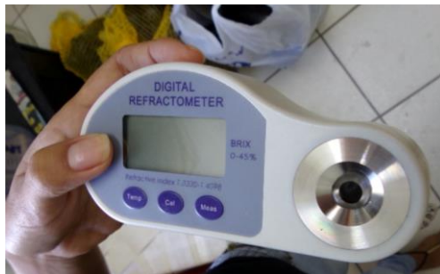
Figura 4. Refratômetro digital utilizado para a leitura de sólidos solúveis.
