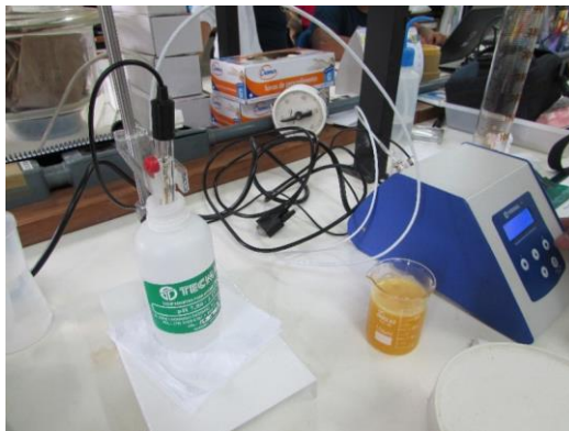
Figura 6. Estabilização do peagâmetro, para depois obter a leitura do suco de tangerina.
