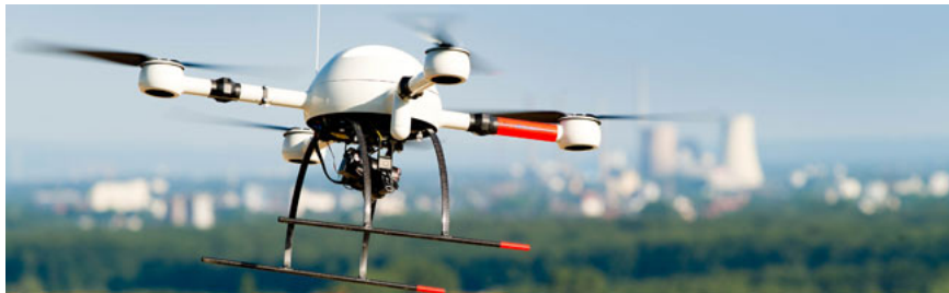
Figura 1 – Foto do VANT utilizado no cenário de aplicação (modelo md4-1000). Fonte: (16).
