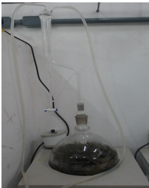
Figura 2 - Hidrodestilação em aparelho de Clevenger.
