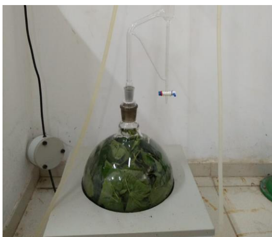
Figura 2. Hidrodestilação em aparelho de Clevenger. Fonte: Autor, 2019.
