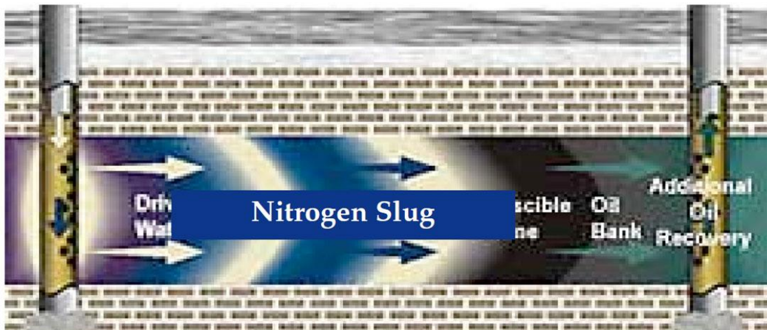
Figura 17 - Processo de injeção de nitrogênio de deslocamento miscível
