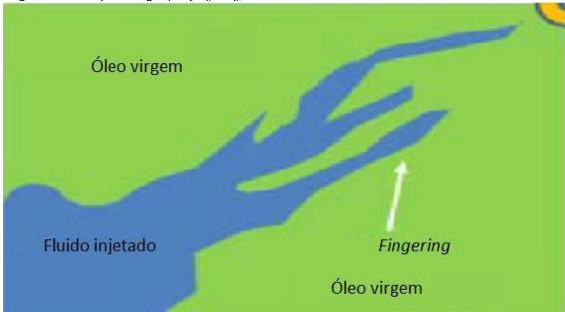
Figura 3 - Formação de digitação ( fingering ) do fluido deslocante no óleo
