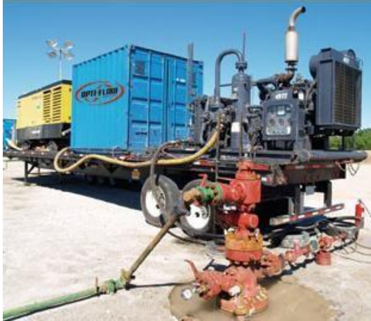
Figura 13 - Unidade de geração de nitrogênio in situ
