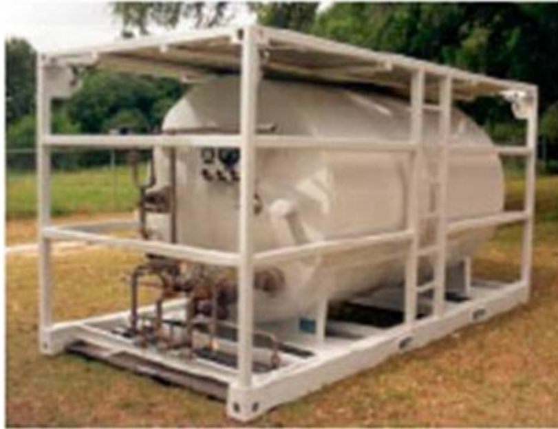
Figura 15 - Tanque criogênico offshore com 2000 gal. de capacidade
