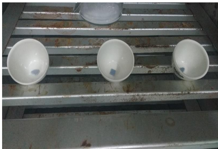
Figura 11: Filmes finos de \text{Bi}_{0,5}\text{Na}_{0,5}\text{TiO}_3 - \text{BaTiO}_3 após o tratamento térmico a 600^\circ\text{C} (à esquerda), 650^\circ\text{C} (centro) e 700^\circ\text{C} (à direita).
