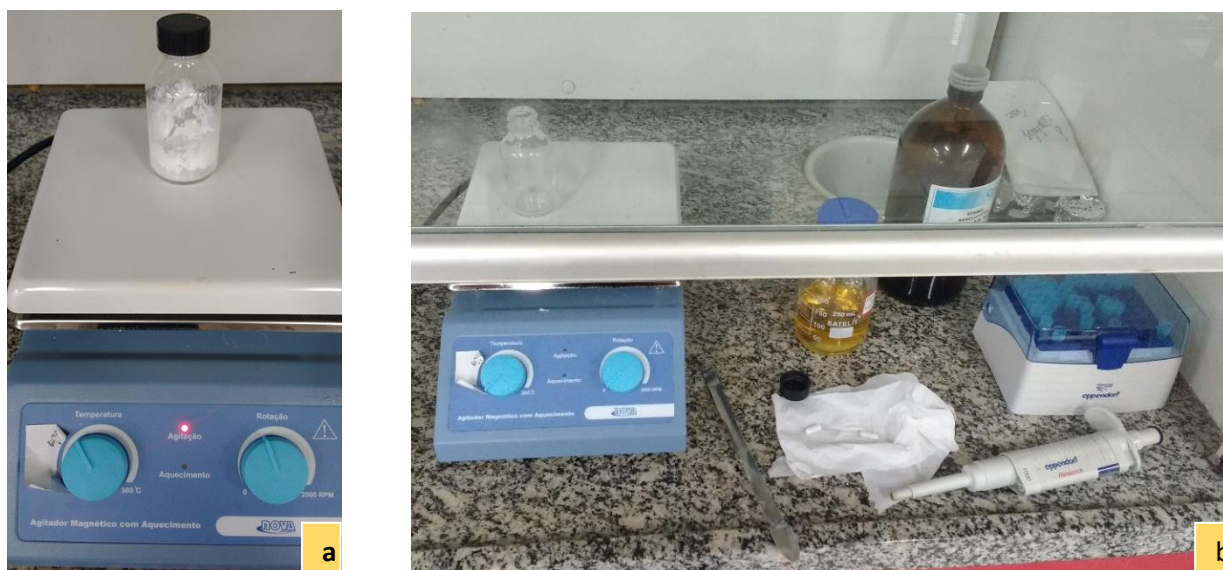
Figura 8: Preparação da solução de BaTiO 3 . a) Amostra em agitação. b) Materiais
