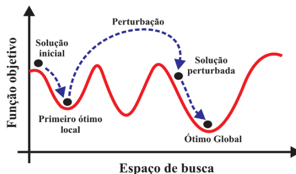
Figura 4 - Funcionamento do algoritmo ILS em um determinado espaço de busca.
