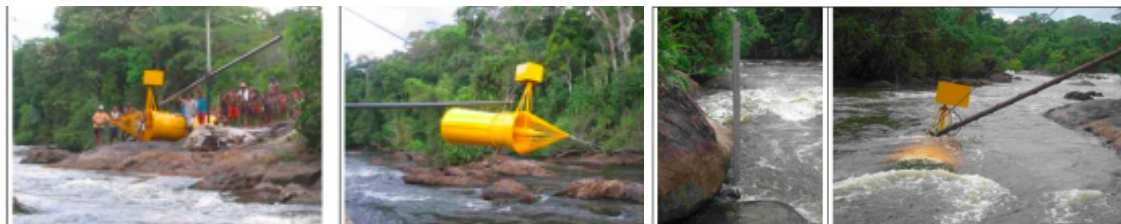
Figura 5 - Turbina Geração 2 em operação
