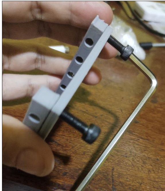
Figura 28. Junção da placa de Arduino e feixe 9x1
