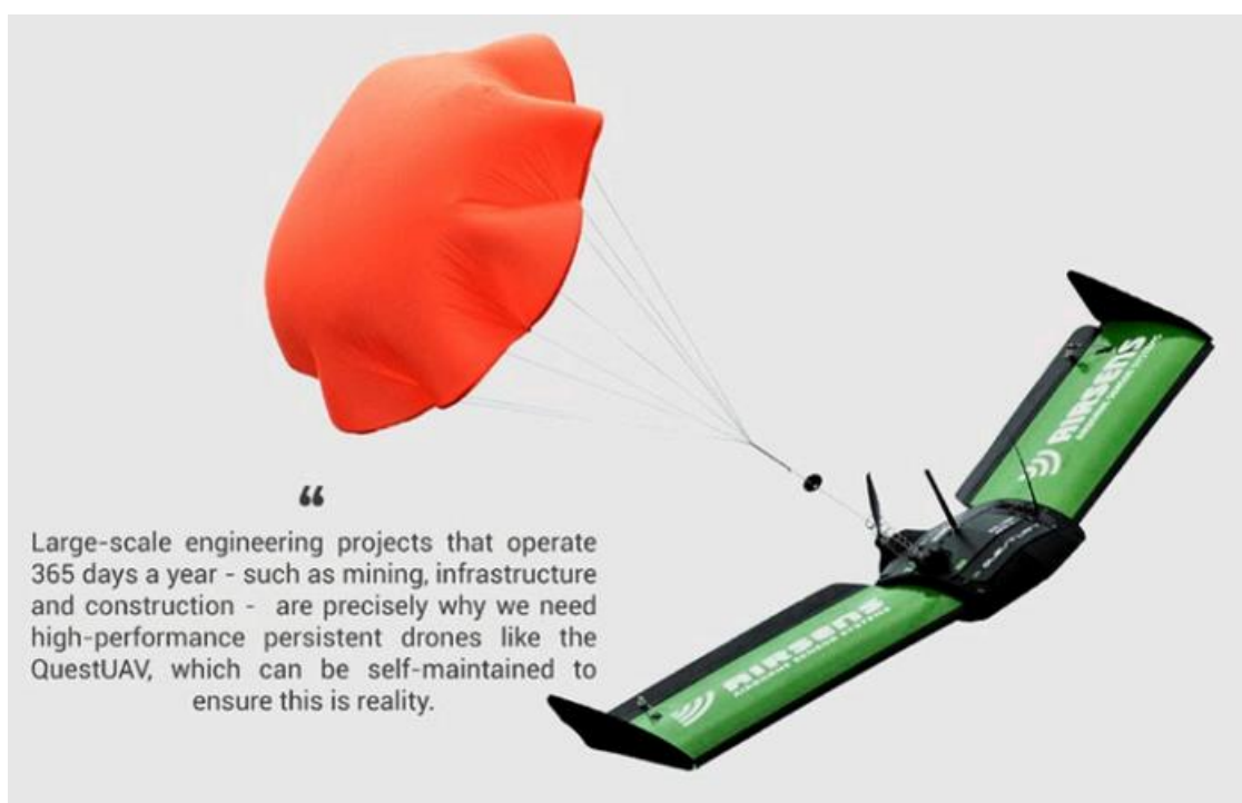
Figura 6 — Recurso de pouso com paraquedas para um drone de asa fixa
