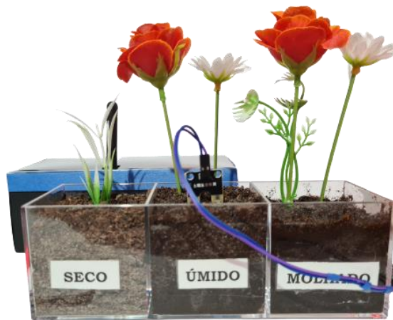
Figura 4.3: Sensor de umidade do solo inserido em solo úmido.
