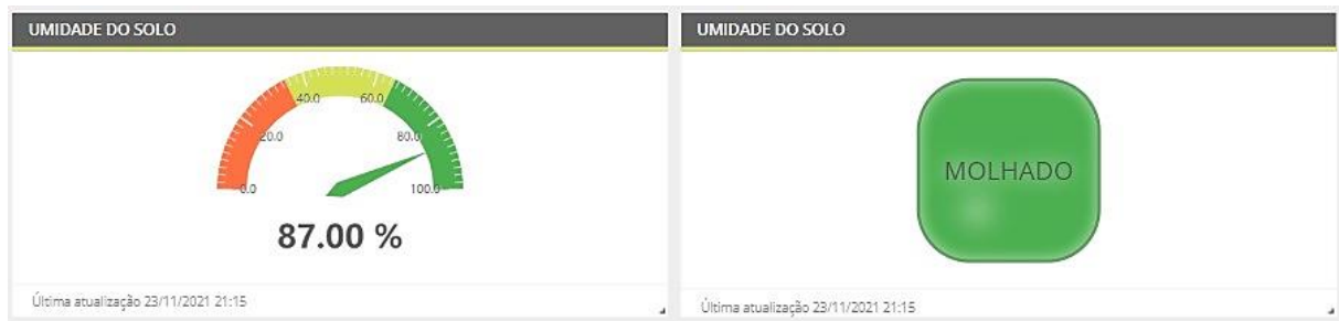
Figura 4.2: Umidade do solo molhado sendo mostrada no dashboard da ProIoT.
