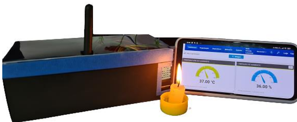
Figura 4.8: DHT11 captando valores de umidade e temperatura após ser submetido à ação de uma fonte externa de calor.
