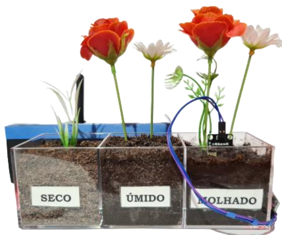
Figura 4.1: Sensor de umidade do solo inserido em solo molhado.
