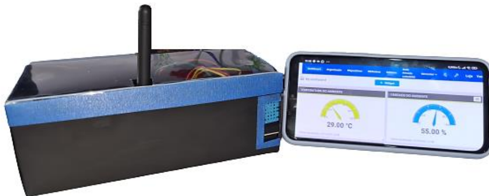
Figura 4.7: DHT11 captando valores de umidade e temperatura em ambiente real e aberto.
