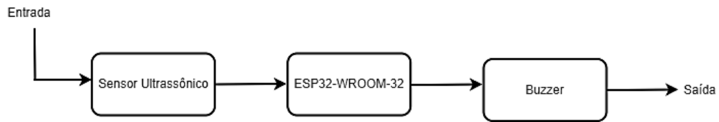
Figura 3.19: Diagrama em blocos do sistema de prevenção contra predadores.
