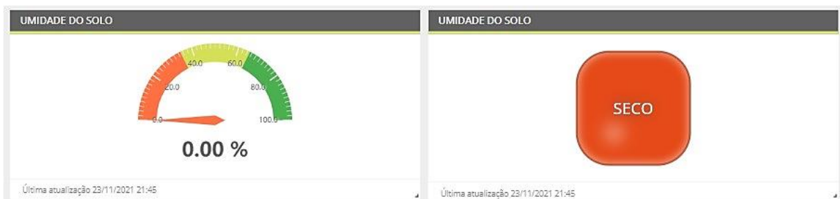
Figura 4.6: Umidade do solo seco sendo mostrada no dashboard da ProIoT.
