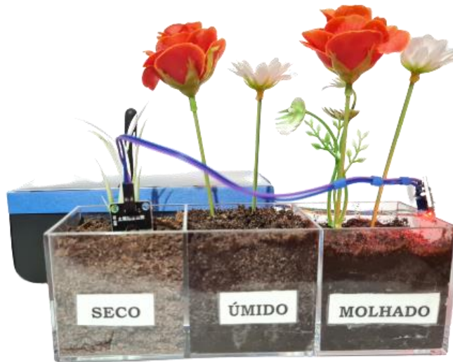
Figura 4.5: Sensor de umidade do solo inserido em solo seco.
