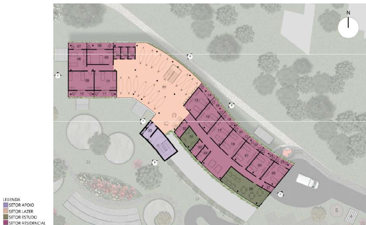
Figura 109 – Planta baixa 5º pavimento. 1: Redário; 2, 3 e 4: Banheiros; 5 ao 26: Quartos duplos com varandas; 27: DML; 28 e 31: Salas de estudos; 29, 30 e 32: Banheiros; 33: Escada enclausurada.
