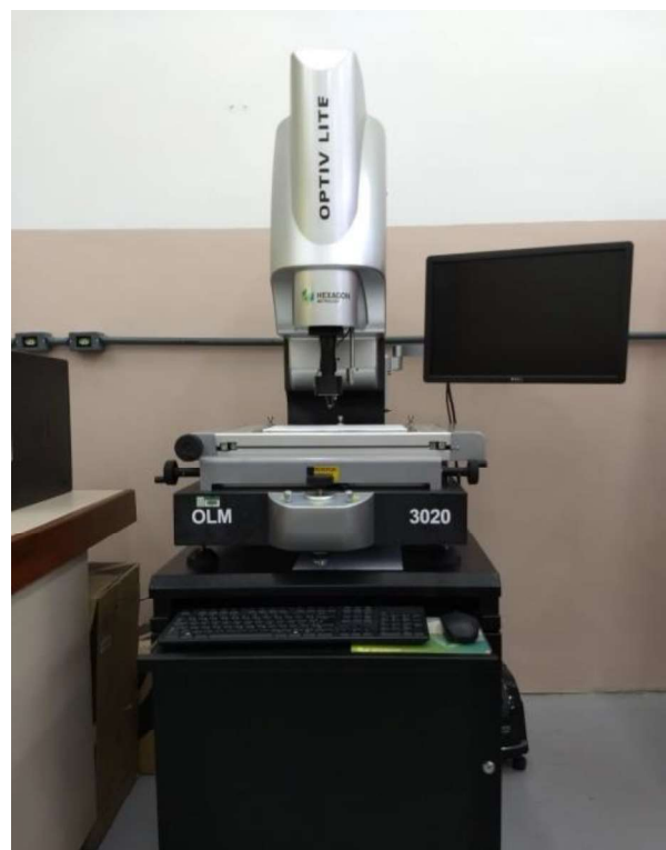
Figura 3.7 - Sistema óptico de medição OLM 3020 Hexagon
