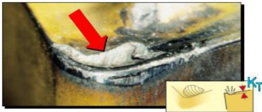
Figura 2.14 - Mecanismo de difusão ocorrido na superfície de saída da ferramenta
