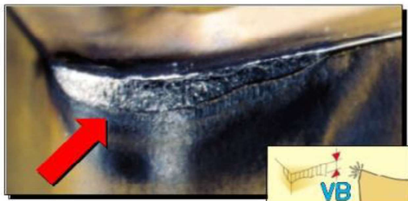
Figura 2.15 - Mecanismo de abrasão na ferramenta de corte
