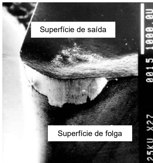
Figura 2.11 - Exemplo de desgaste de flanco para um inserto de diamante CVD na usinagem de MMC
