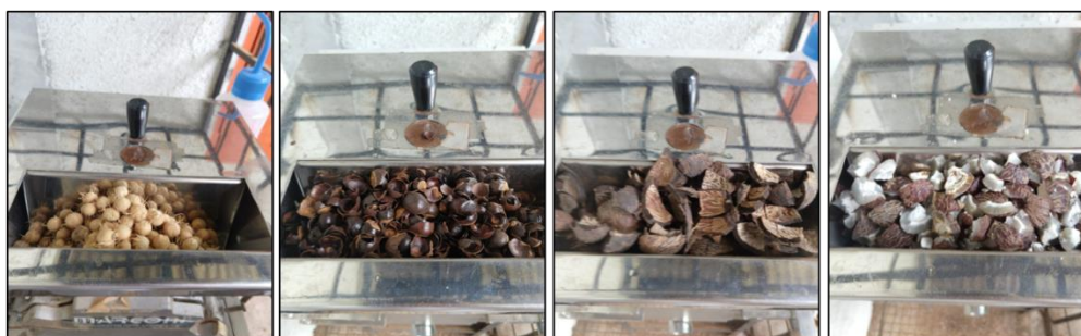
Figura 03. Amostras sendo inseridas no moinho de facas, da esquerda pra direita, os caroços do açai, os casquilhos do guaraná, o endocarpo do caroço de tucumã e a amêndoa do caroço de tucumã. Fonte: próprio autor.
