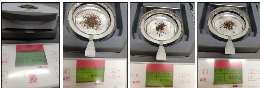
Figura 05. Aparelho analisador de umidade com as amostras do caroço do açaí, endocarpo do tucumã e amêndoa do tucumã.
