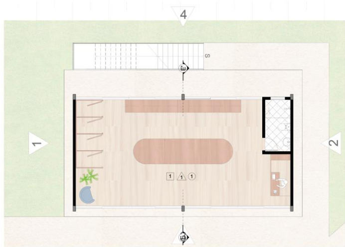
LEGENDA ACABAMENTOS: 1. PISO: CERÂMICA CLAREADA; 2. PAREDE: REVEST. CORTIÇA/PAUVA TINTA BRANCA; 3. TETO: APARELHO CLAREO REQUADRO; PLANTA-BAIXA TÉRREO (UCT1)
