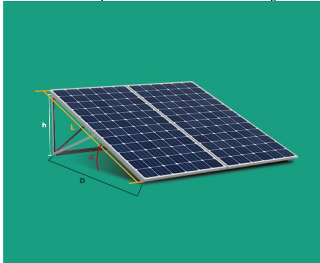
Figura 17: A altura da haste de suporte do módulo determina o ângulo de inclinação
