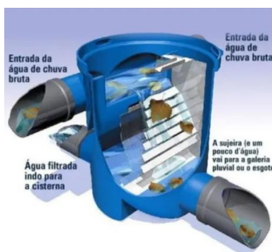
Figura 50: Esquema do funcionamento do filtro para captação de águas pluviais. Fonte: Mercado Livre.
