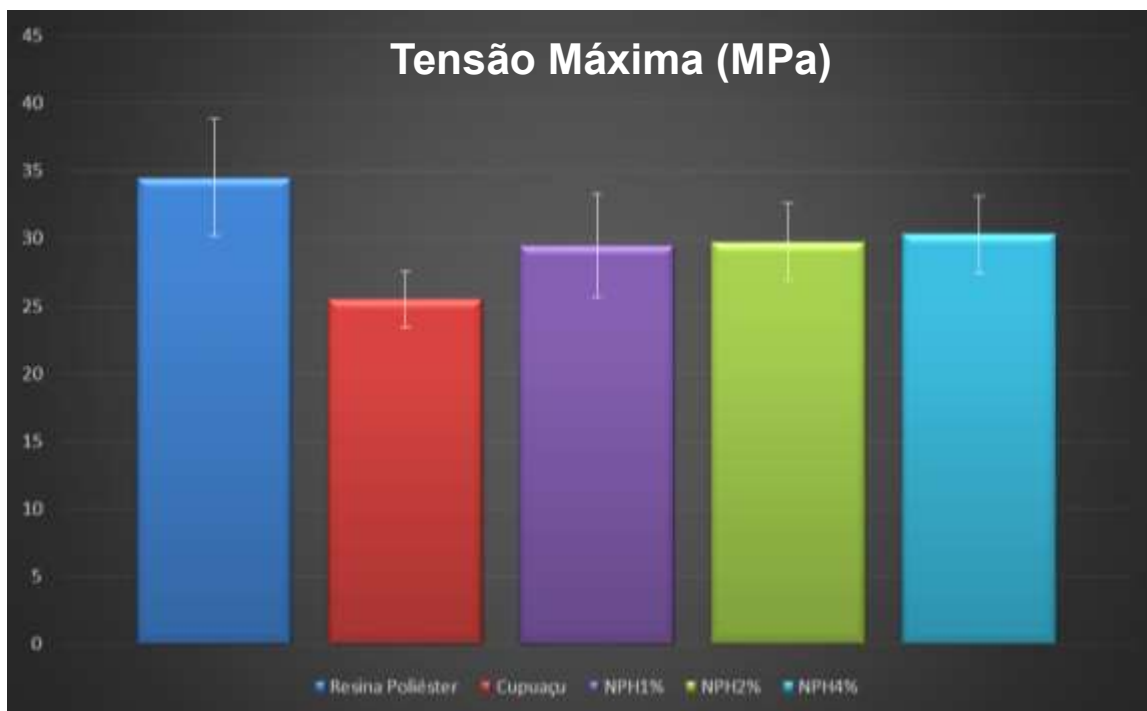
Figura 22. Resistência à tração do poliéster puro e do poliéster com adição da casca do cupuaçu e com nanopartículas de haloisita.
