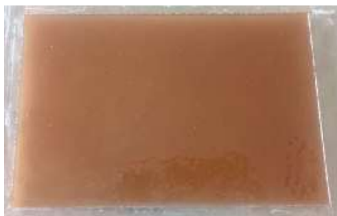
Figura 13. Exemplo de uma das placas preparadas (2% de cupuaçu, com 2% de nanopartículas).
