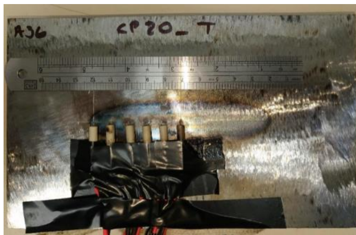
Figura 4-2: Termopares soldados na face oposta (imagem obtida após soldagem). Fonte: Cruz Neto (2018).
