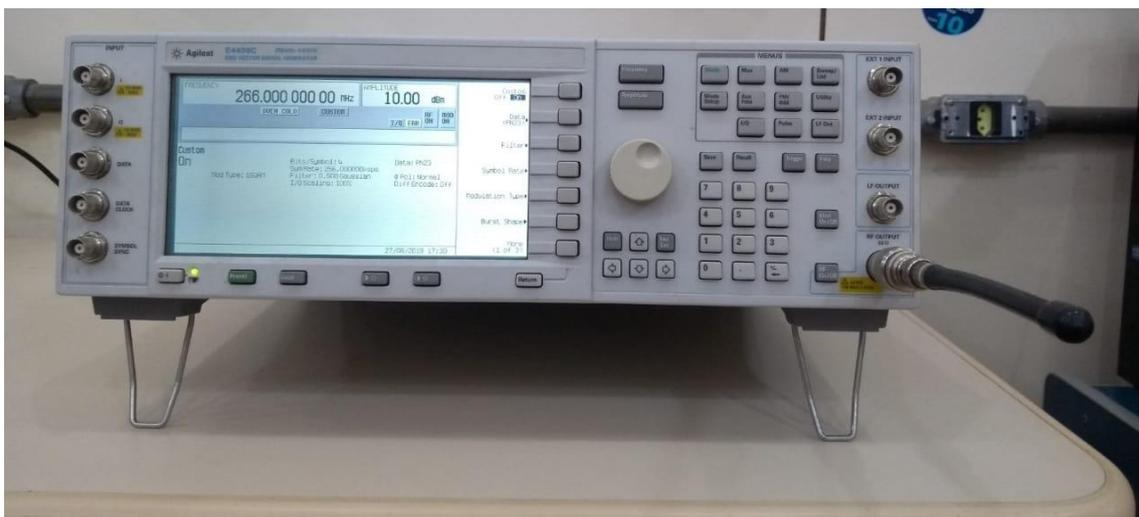
Figura 3.2: Equipamento responsável pela geração dos sinais modulados em banda passante.
