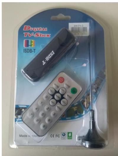
Figura 4.1: Dispositivo utilizado para captura dos sinais modulados.
