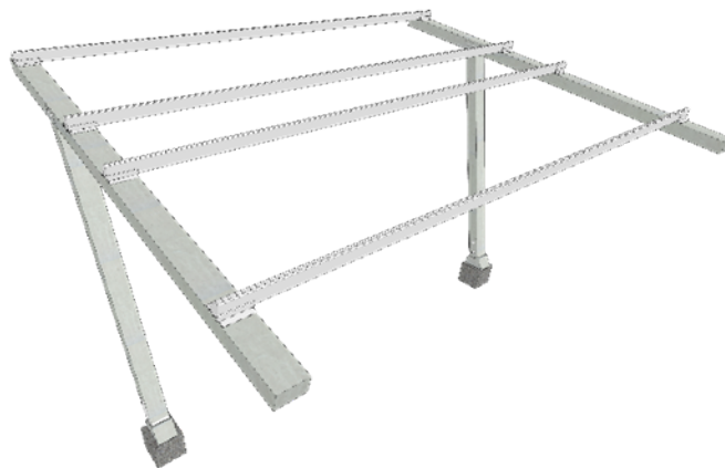
Figura 35 Vista de um módulo da estrutura para painéis solares
