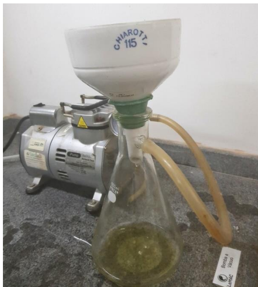
Figura 10: Filtragem a vácuo utilizada para retirar excesso de água das fibras
