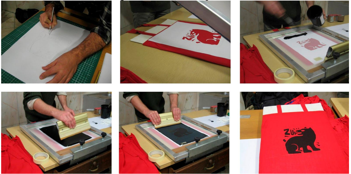
Figura 4: Processo de serigrafia
