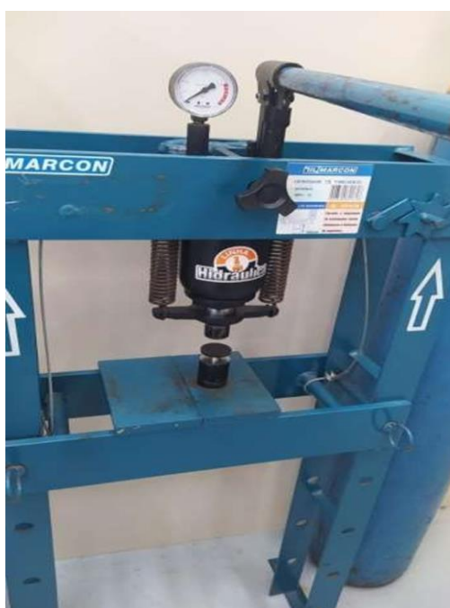
Figura 13: Prensa hidráulica (15 kN) utilizada para produção dos corpos de prova.
