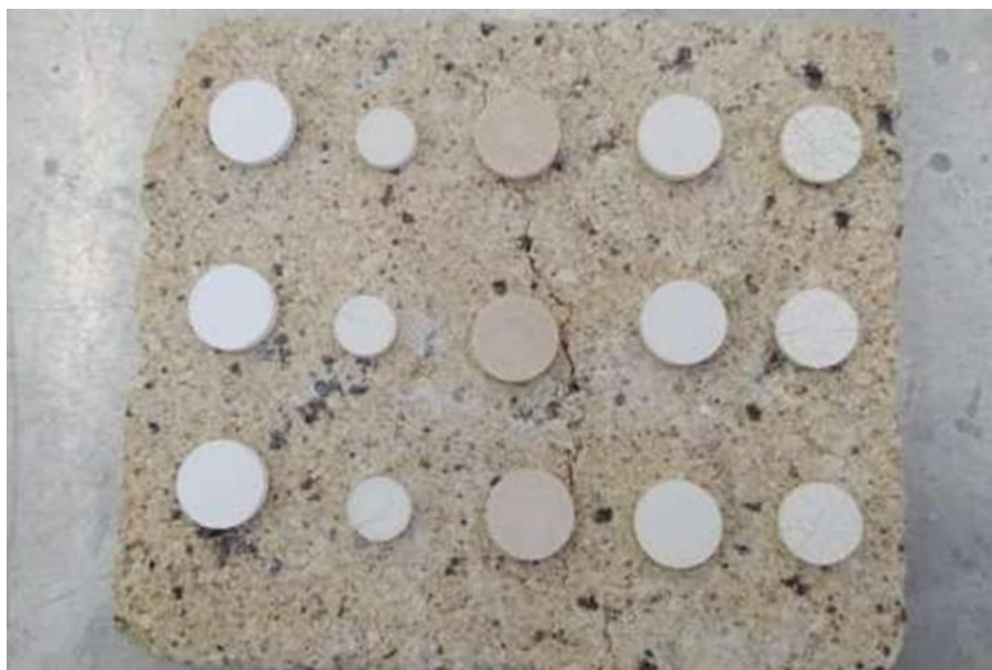
Figura 30: Corpos de prova em triplicata prensados depois de serem sinterizados.
