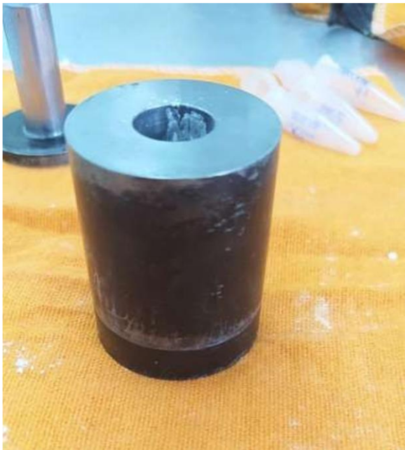
Figura 12: Molde metálico para confecção de corpo de prova possuindo d = 15 \text{ mm}
