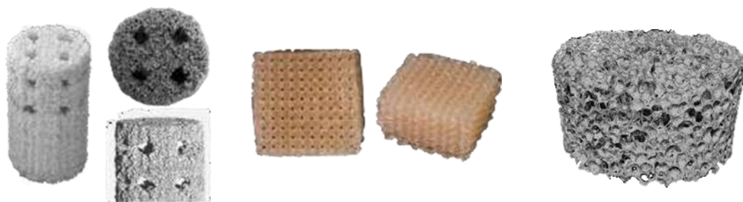
Figura 02: Exemplos de como é a estrutura de um Scaffold .
