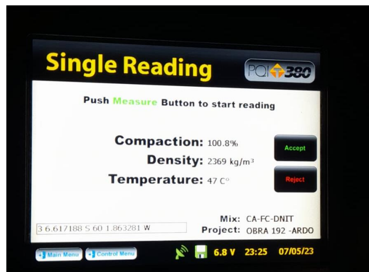
Figura 5: Resultado do ensaio de densidade in situ
