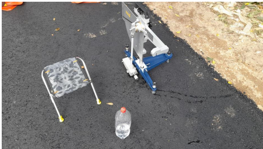
Figura 2: Pêndulo britânico adotado para o ensaio de microtextura
