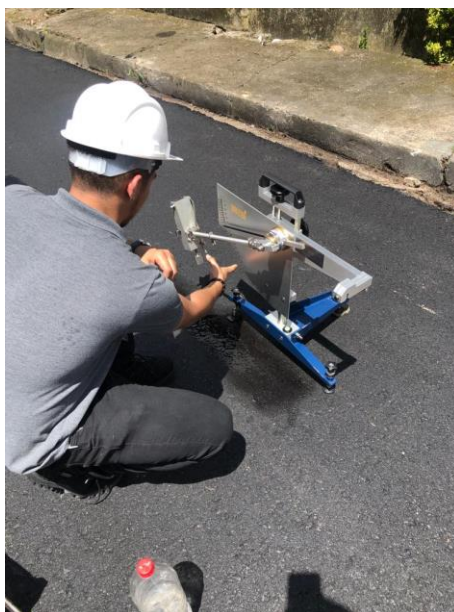
Figura 12: Análise da microtextura pelo pêndulo Britânico.
