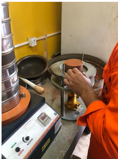
Figura 03: Extração de amostra de solo compactada.
