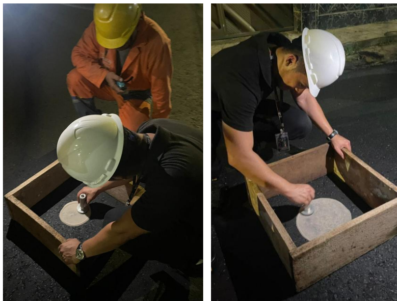
Figura 11: Análise da macrotextura pela mancha de areia.
