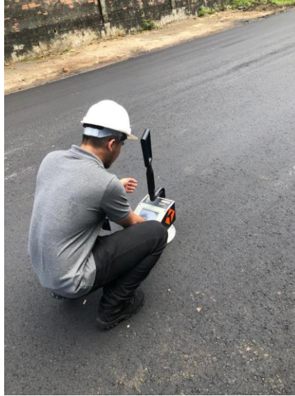
Figura 10: Utilização do densímetro não nuclear.
