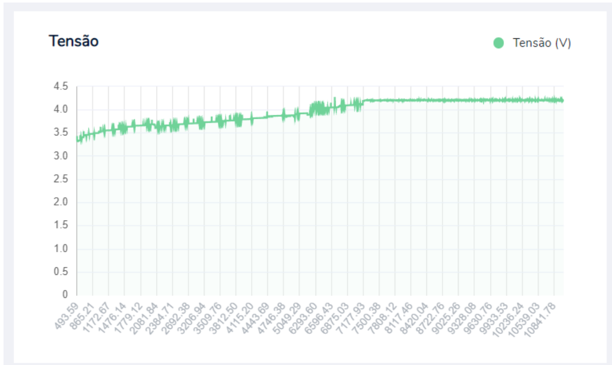
Figura 5.5: Gráfico da tensão na bateria durante o carregamento CC-CV. Elaborado pelo autor.
