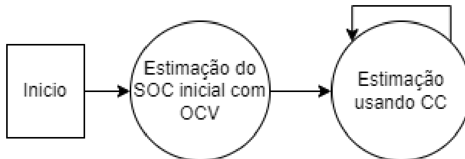
Figura 4.3: Diagrama de estados da estimação de SOC. Elaborado pelo autor.
