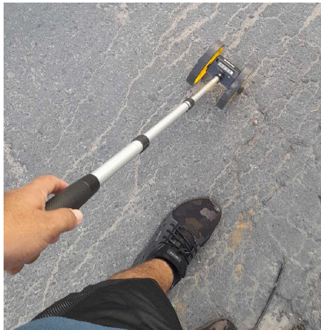
Figura 10 - Medição de estacas e classificação de patologias em pavimentos
