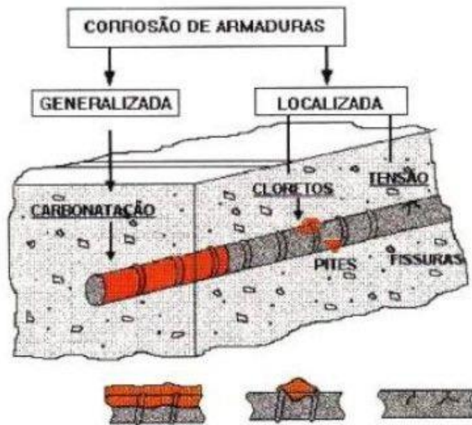
Figura 3 - Classificação dos tipos de corrosão de armadura
