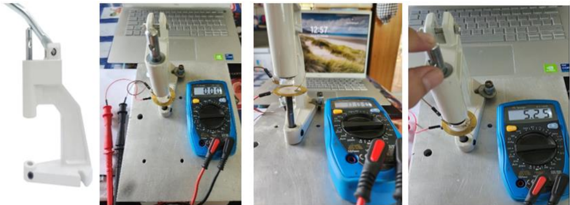
Figura 15 – Protótipo 1A para teste das pastilhas piezoelétricas.
