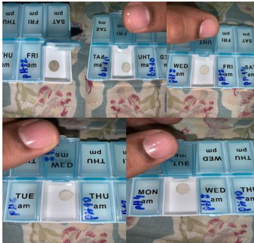
Figura 15: Pastilhas cerâmicas de Titanato de Sódio utilizadas como termistores (pH 14,12,10,8 e 6)
