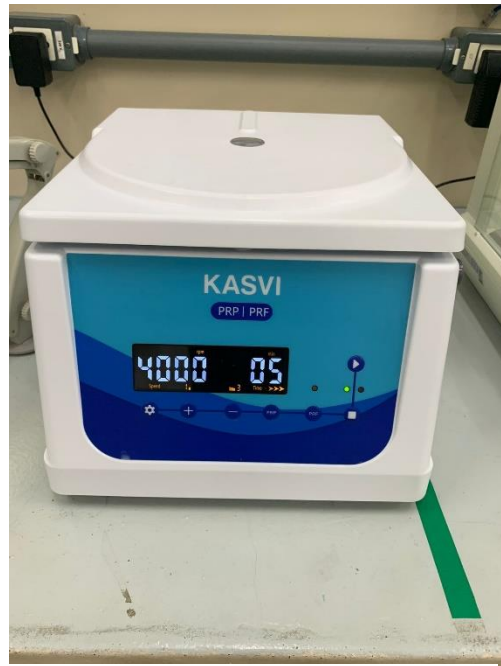
Figura 7: Uso da centrífuga para separação do material
