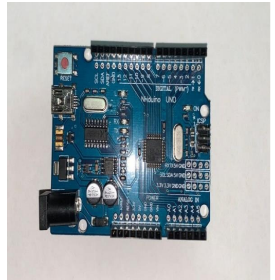
Figura 9 : Arduíno modelo Uno R3 utilizado no experimento
