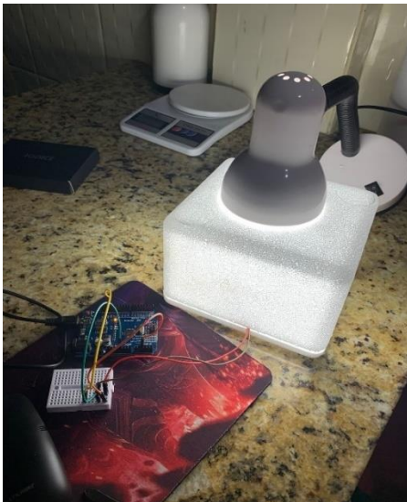
Figura 13: Montagem do circuito com a pastilha cerâmica dentro de uma fonte de calor caseira simulada pelo autor
