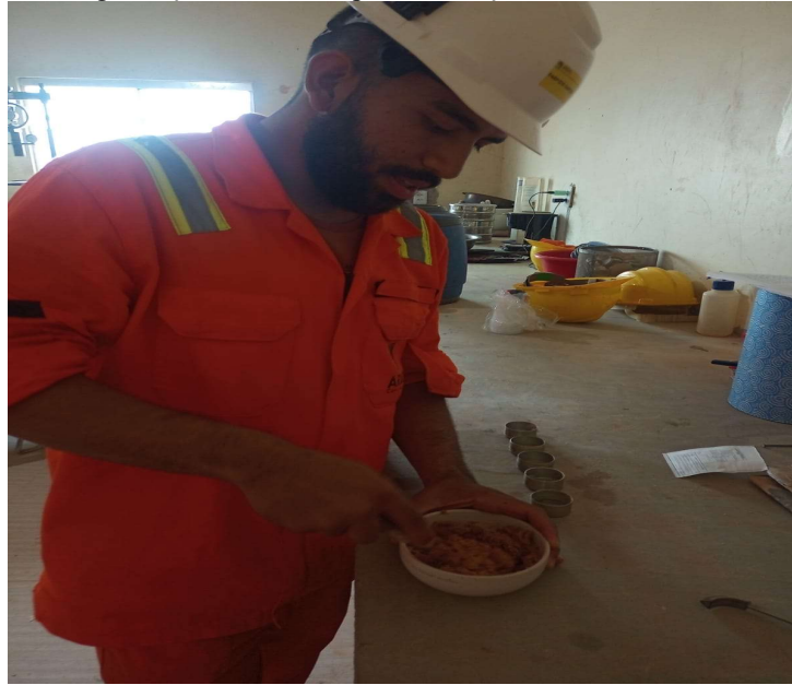
Figura 06: Homogenização da amostra para realização do ensaio de limite de liquidez
