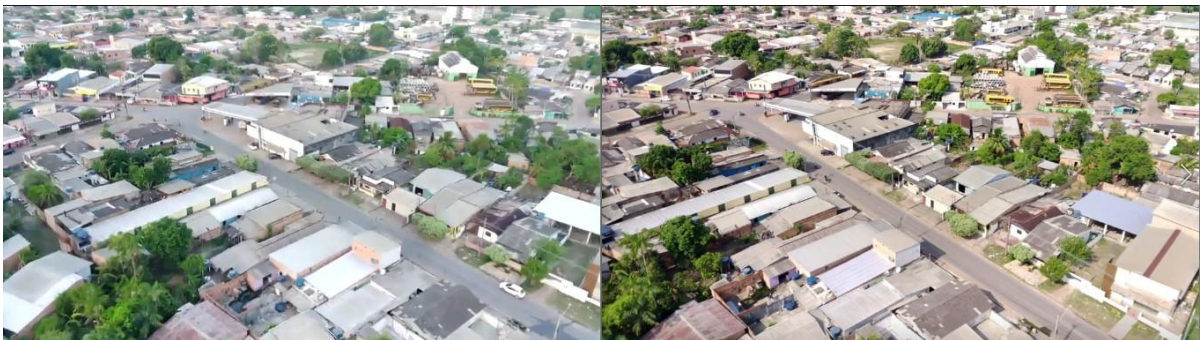
Figura 17. Comparativo entre imagens transmitidas em streaming com fluidez de imagem (imagem à esquerda) e alta qualidade de imagem (imagem à direita)
