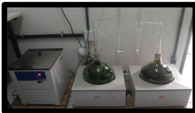
**Figura 2** - Sistema de Hidrodestilação utilizado.
