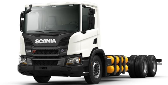
Figura 8 - Scania P-280 movido a gás natural comprimido
