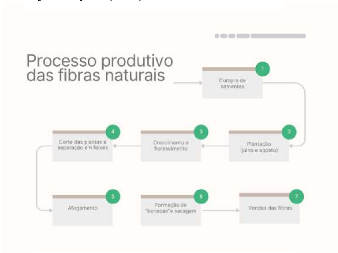
Figura 1: Fluxograma do processo produtivo das fibras naturais
